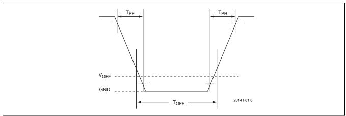
FIGURE 1: RECOMMENDED POWER-UP/DOWN WAVEFORM
